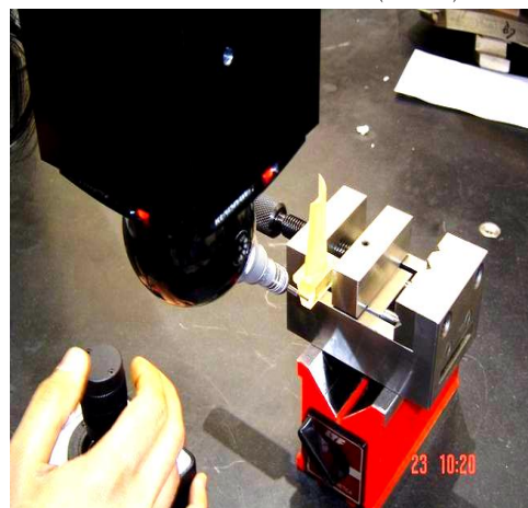
شکل (۶): عملیات اندازه گیری قطعه ساخته شده بوسیله استریولیتوگرافی و مقایسه آن با مدل پره
