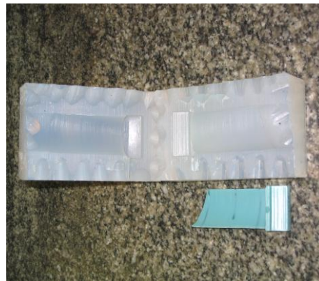
شکل (۹): تولید مدل مومی بوسیله قالب اپوکسی
