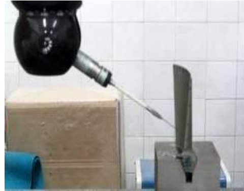
شکل (۱): عملیات داده برداری پره نمونه بوسیله دستگاه CMM
